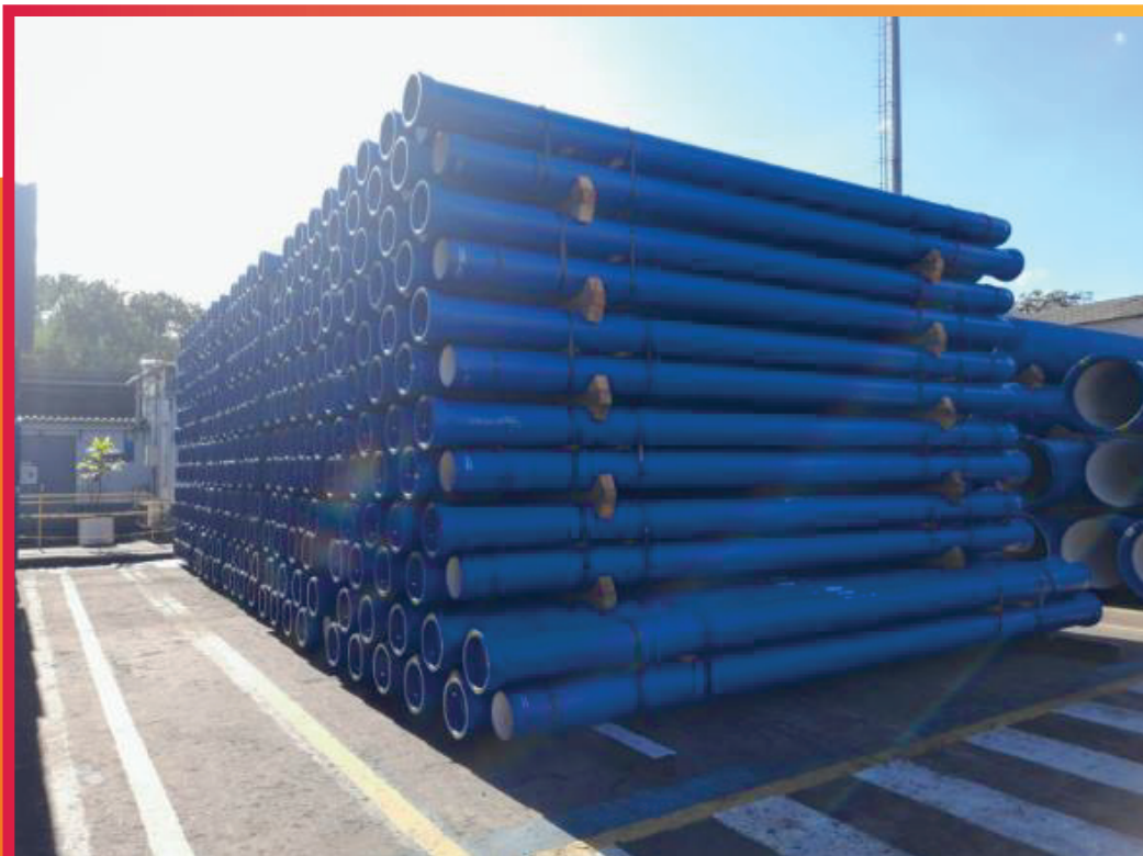
↘ Estocagem Fábrica - DN 250
