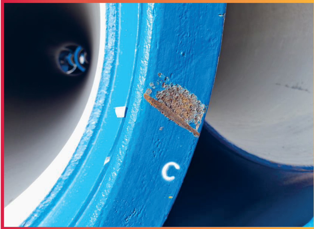
↘ Atrito tubo x tubo na descarga
