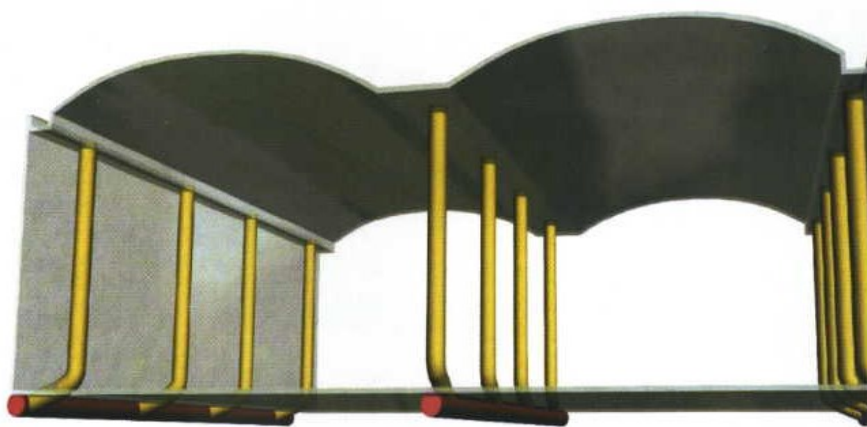
Figura 2 – Exemplo de captação gravitacional de águas pluviais
