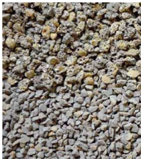
MONO-MULTI: Filtralite no trabalho, note sua natureza porosa e camadas distintas
